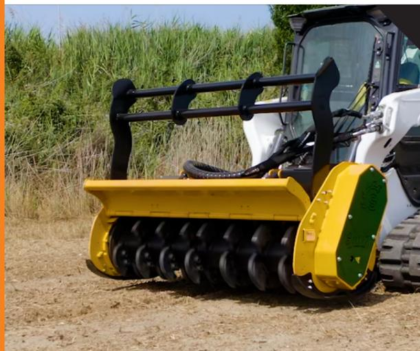
Trinciatrice per caricatori tra 3 e 9 tonnellate con ruote o cingolati, utilizzato in lavori di decespugliamento e manutenzione forestale, giardinaggio industriale, ecc. Combina la manovrabilità di un caricatore rigido e le prestazioni di una trinciatrice.
