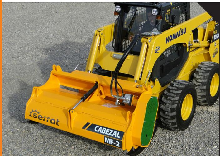
Testata trinciante adattabile per essere installata nei bracci di elevazione di minicaricatori fino a 5 TM, azionato attraverso circuito idraulico ausiliare esistente.
