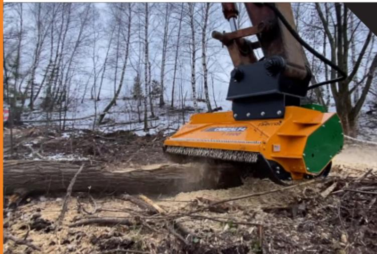
Testata trinciante adattabile a scavatrici tra 15 – 25 TM.
