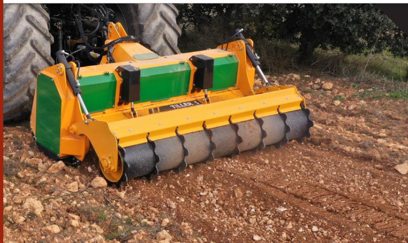
Macchina per la preparazione del terreno con una profondità di lavorazione fino a 300 mm, per trattori tra 130 e 180 CV.
