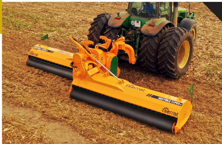
L' Abatible Super + è una composizione di due macchine standard unite da un corpo centrale con un sistema di auto piegaggio. La composizione può arrivare a 7,30 m.
