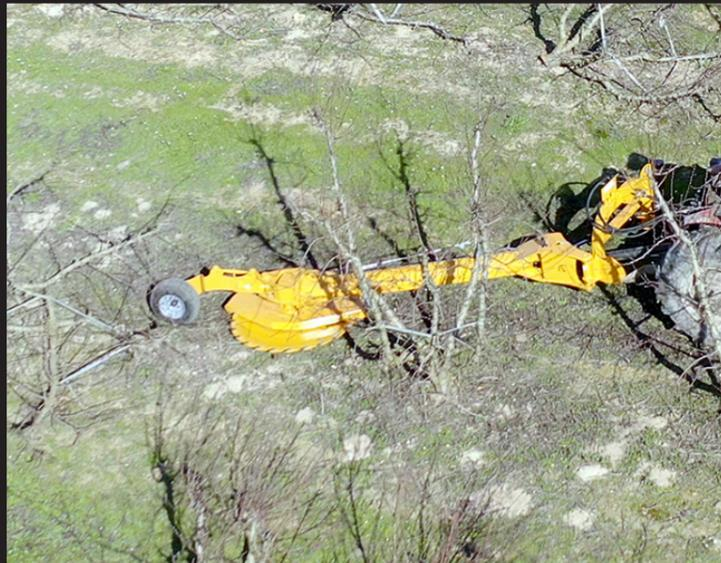
Disco di asse verticale ad azionamento meccanico per tagliare i tronchi di alberi da frutta. Fino a 150-200 mm di diametro.
