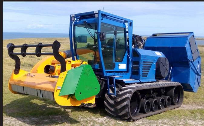
La trinciatrice BIOSYLVA, in un solo passaggio e alla velocità abituale, è capace di tagliare e lanciare l'erba e la ramaglia fino a 100 mm di diametro dentro ad un rimorchio per recuperarlo dal terreno.
