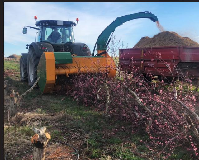
Cippatrice per recuperare il materiale legnoso per trattori da 300 CV fino a 500 CV. Sistema di avviamento con HIDRAHELP.
