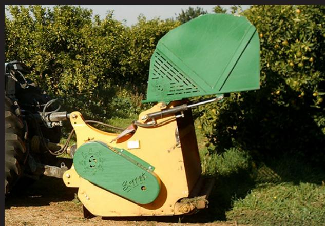
Trinciatrice adatta per il taglio e la raccolta di erba e rami fino a 80 mm di diametro.
