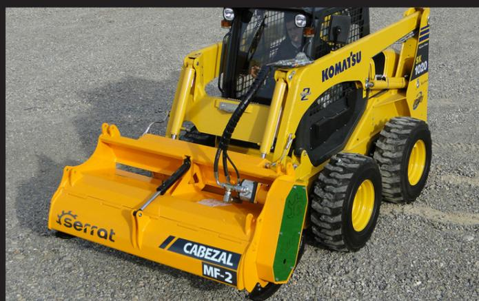
Testata trinciante adattabile per essere installata nei bracci di elevazione di minicaricatori fino a 5 TM, azionato attraverso circuito idraulico ausiliare esistente.
