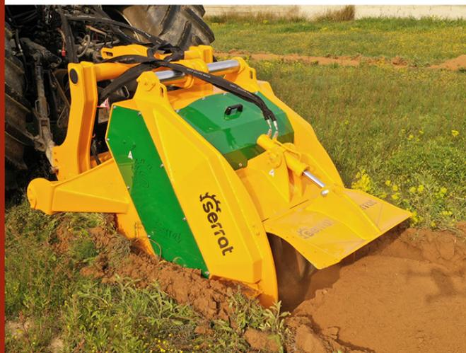
Macchina per la preparazione del terreno con una profondità di lavorazione fino a 400-500 mm, per trattori tra 200 e 350 CV.
