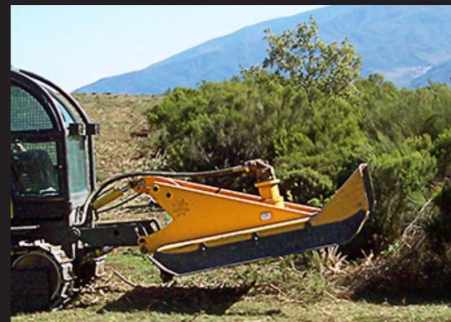
Decespugliatrice forestale di catene con telaio monocasco con spessore di 15 mm. Gruppo fino 160 CV. Ideale per decespugliamento forestale, creazione di passaggi, sottobosco e linee elettriche, per cespugli alti fino a 80 mm.
