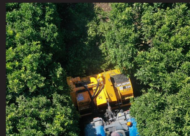
Trinciatrice con doppio alimentatore idraulico ideale per residui di potatura di olivo, agrumi e frutta a guscio, per materiale fino a 100 mm di diametro. Incorpora rotore SPLINTER di SERRAT per trattori da 90 a 160 CV.
