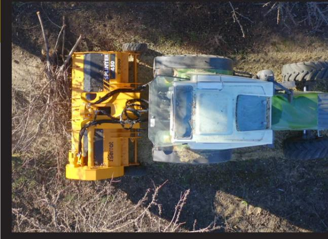
Trinciatrice con doppio alimentatore idraulico ideale per residui di potatura di olivo, agrumi e frutta a guscio, per materiale fino a 80 mm di diametro. Incorpora rotore SPLINTER di SERRAT per trattori da 70 a 140 CV.
