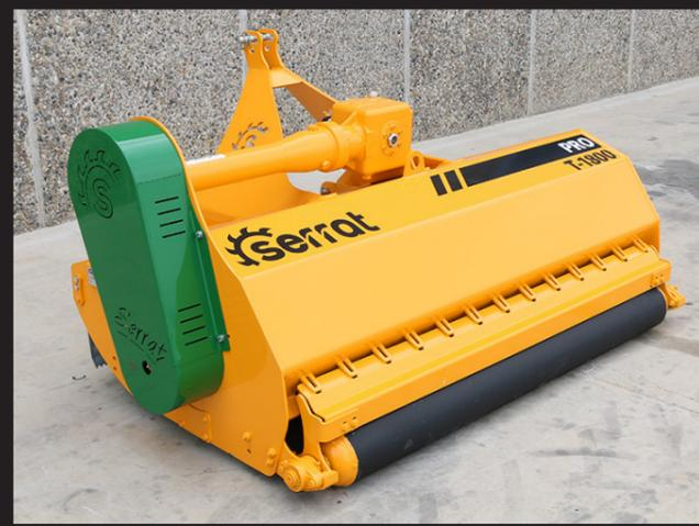
Si utilizza per trinciare rami da potatura, residui dei coltivi estensivi, pascoli, parchi e giardini. È una trinciatrice ad uso universale e di altissima affidabilità. Rotore POLSER di Ø 550 mm. Di diametro per legno fino a 100-120 cm. La sua configurazione fissa permette di posizionare il gruppo per allineare il lavoro all'asse del trattore.
