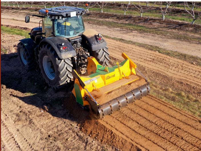
Macchina per la preparazione del terreno con una profondità di lavorazione fino a 500 mm, per trattori tra 300 e 600 CV.
