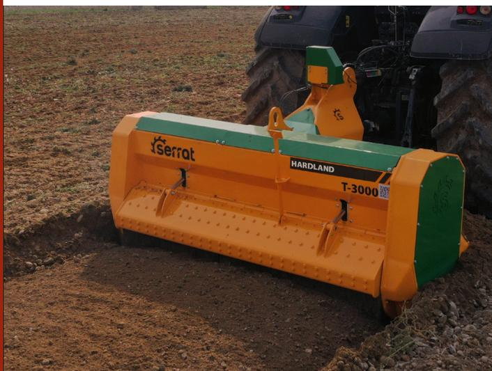
Macchina per la preparazione del terreno con una profondità di lavorazione fino a 500 mm, per trattori tra 350 e 650 CV.
