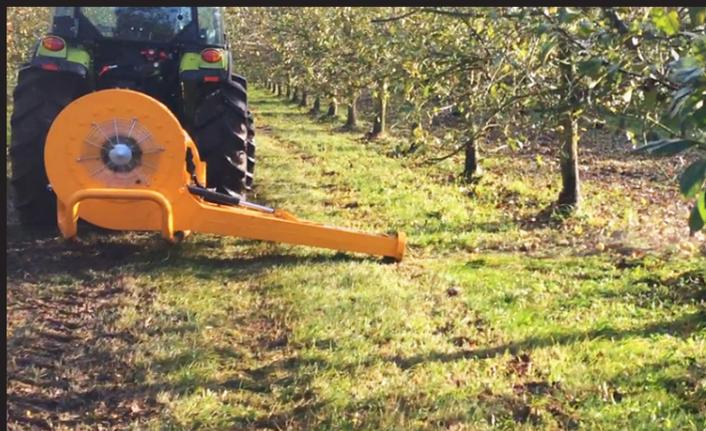
Turbina per lo spostamento di foglie e frutti in agricoltura e giardinaggio. Azionata attraverso la presa di forza di un trattore agricolo o di un porta attrezzi.
