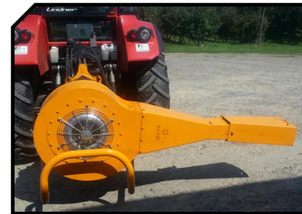
Particolare rotazione ed effusore idraulico
