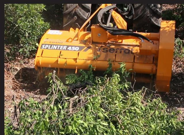
Trinciatrice con doppio alimentatore idraulico ideale per residui di potatura di olivo, agrumi e frutta a guscio, per materiale fino a 6-8 cm di diametro. Incorpora rotore SPLINTER di SERRAT per trattori da 70 a 140 CV.
