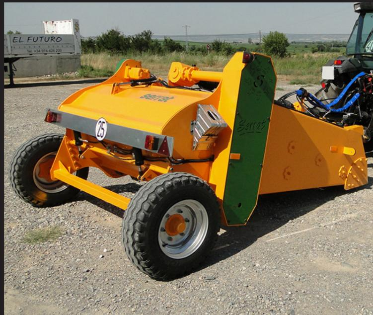
Trinciatrice di pietre con sistema di caricamento continuo per la taratura di terreni ad uso agricolo e orticoli.
