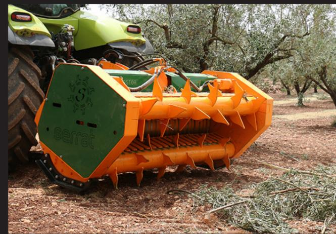
Trinciatrice con alimentatore idraulico reversibile per trattori tra 220-350 CV ideale per l'eliminazione di grandi quantità di legno con Ø fino a 250 mm.
