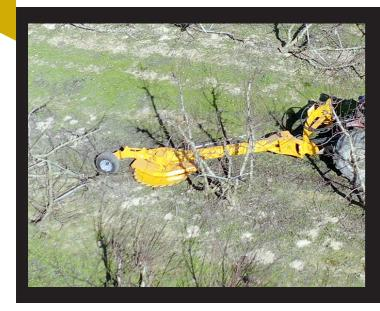
Disco di asse verticale ad azionamento meccanico per tagliare i tronchi di alberi da frutta. Fino a 150-200 mm di diametro.
