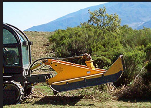
Decespugliatrice forestale di catene con telaio monocasco con spessore di 15 mm. Gruppo fino 160 CV. Ideale per decespugliamento forestale, creazione di passaggi, sottobosco e linee elettriche, per cespugli alti fino a 8 cm.
