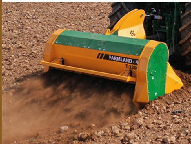
Macchina per la preparazione del terreno con una profondità di lavorazione fino a 40 cm, per trattori tra 150 e 250 CV.
