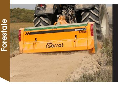
Macchina per la preparazione del terreno con una profondità di lavorazione fino a 50 cm, per trattori tra 250 e 500 CV.
