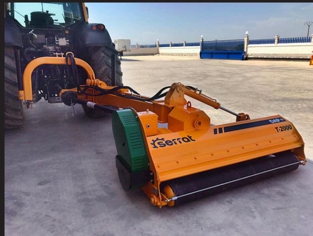
Decespugliatore di alta gamma con rotore di tipo agricolo, multiuso polivalente, laterale e posteriore, per lavori in argini agricoli, canali, autostrade, strade e anche per il decespugliamento in lavori pubblici, per trattori da 120-160 CV.
