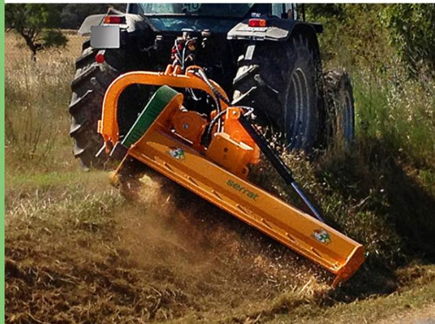
Decespugliatore di alta gamma, multiuso, polivalente, laterale e posteriore, per lavori in argini agricoli, autostrade, canali, strade e anche per il decespugliamento di lavori pubblici, per trattori di 70 – 120 CV.
