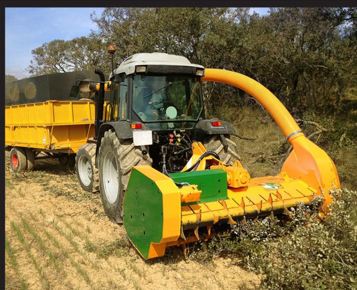
Macchina trinciatrice che recupera i residui da potatura di olivi, frutti secchi e residui forestali, etc. per essere agganciata a trattori di 100 – 150 CV o installata nel trepunte anteriore di un trattore standard di 150 – 180 CV.
