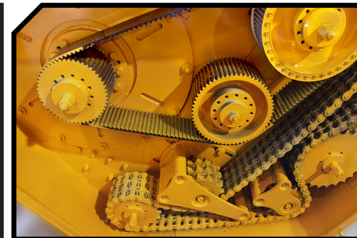
Cinghie sincrone e catena di alimentazione tripla
